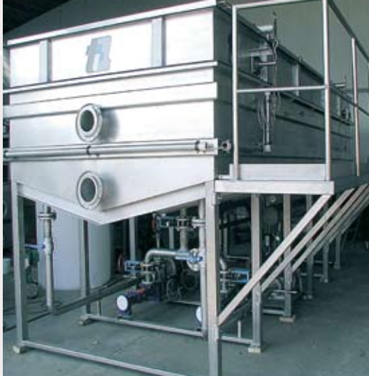
Installation de flottation, système modulaire en acier affiné, TIA (Technologie zur Industrieabwasserbehandlung GmbH)
