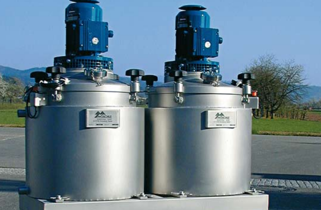
Réservoir de mélange des couleurs, Inomat GmbH, Blieskastel
